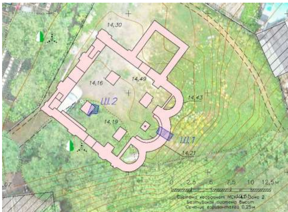
Рисунок 6. – Церковь на Ладожке. Работы 2021 г. Наложение обмерного чертежа Н. Е. Бранденбурга на локализованный фундамент церкви (Окончание)
