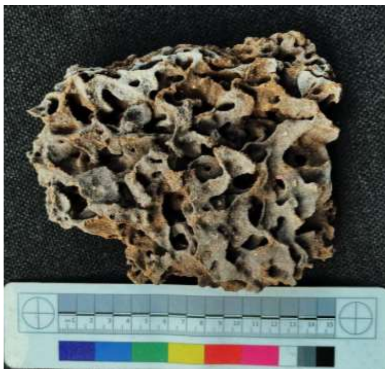
Рисунок 5. – Гнездо муравьев древоточцев, извлеченное из канала разрушенной связи
