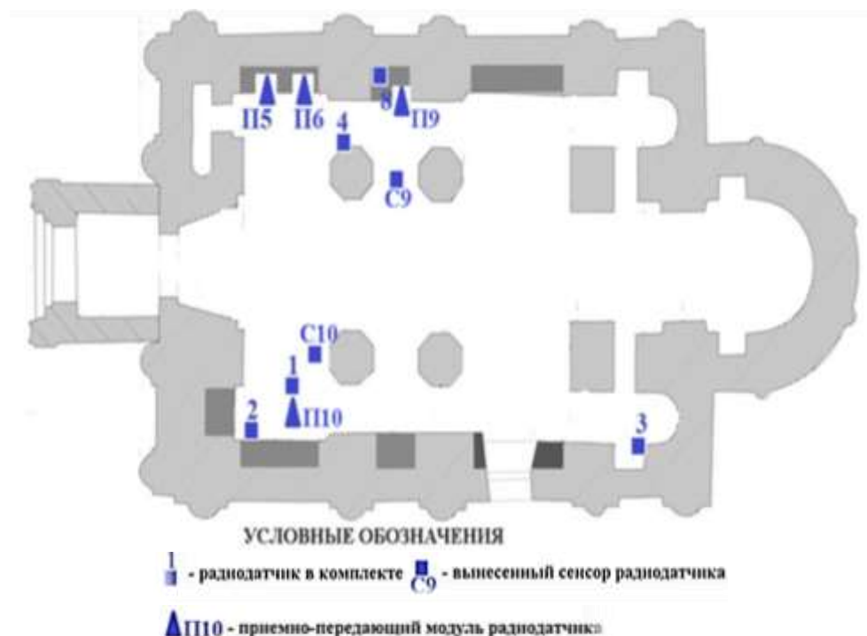
Рисунок 3. – Расположение датчиков системы мониторинга на плане храма
