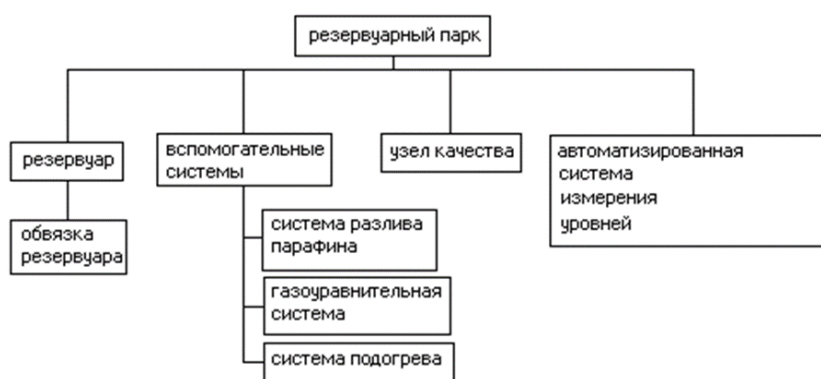
Рисунок 1. – Объекты резервуарного парка
