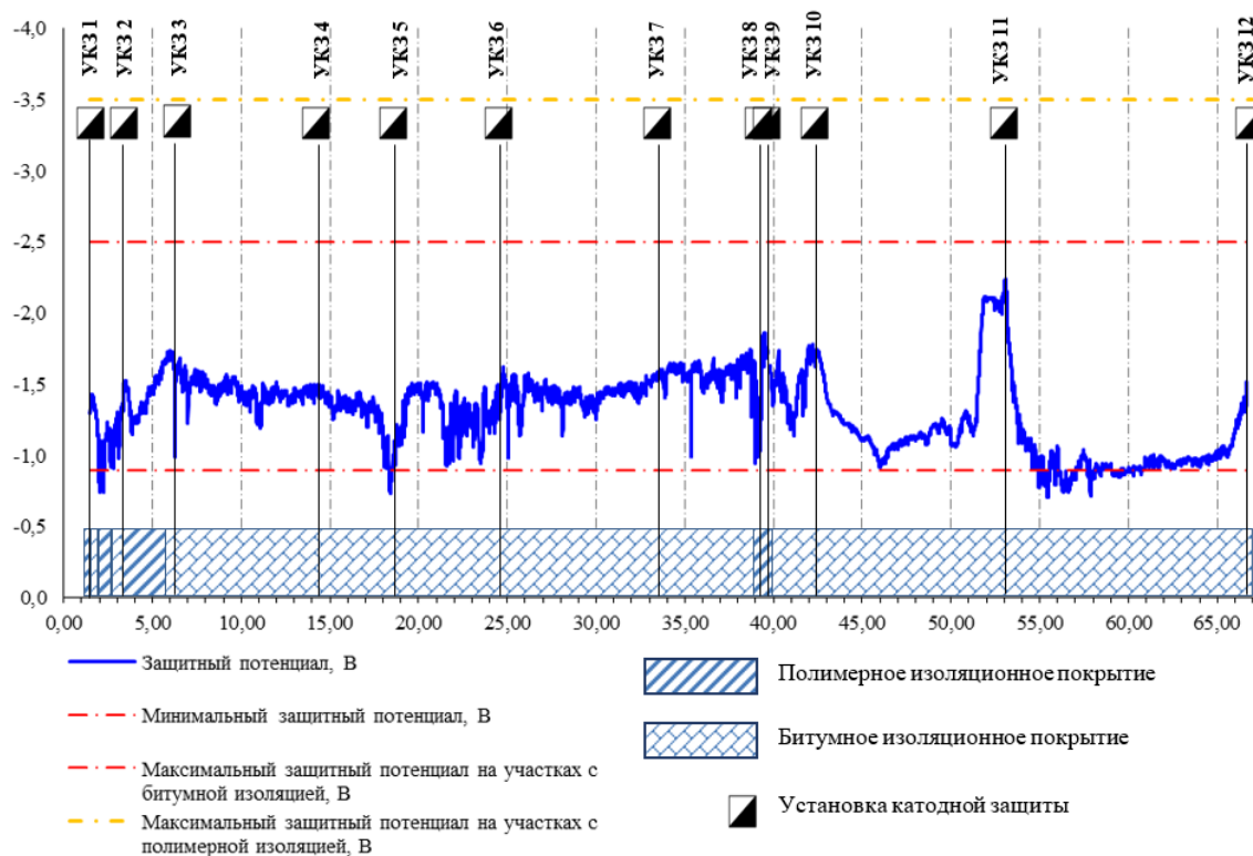
Рисунок 1. – График распределения защитного потенциала по трассе магистрального газопровода
