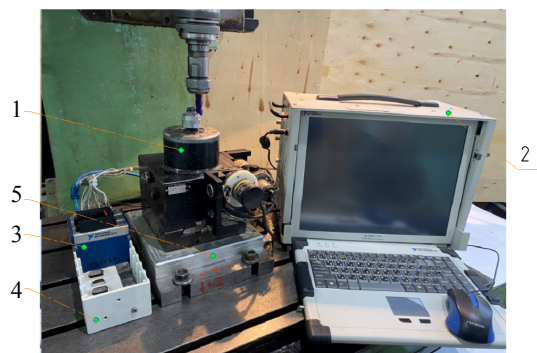
Рис. 3. Программно-измерительный комплекс: 1 – установочное приспособление; 2 – шасси обработки и регистрации данных; 3 – функциональные модули сбора данных; 4 – шасси сбора данных; 5 – первичный тензометрический преобразователь
