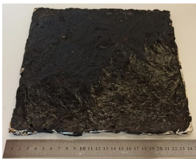
Рисунок 2 – Образец древесного пластика из бересты
