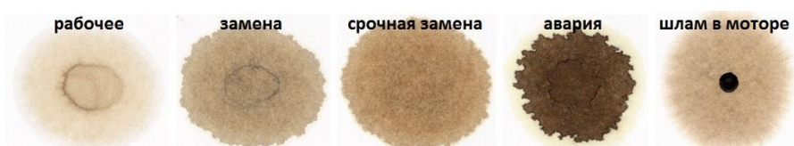
Рисунок 1 –Капельная проба масел, эксплуатируемых в разных условиях
