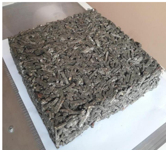
Рисунок 6. – Образец-плита на основе цемента и дробленного хлопчатника
