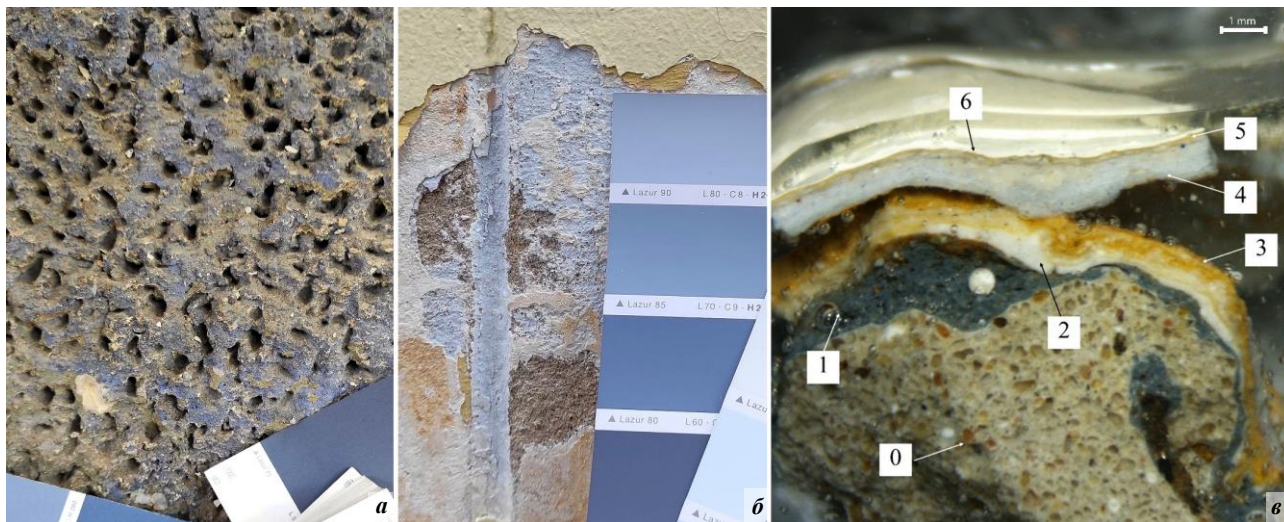
а – раскряцце гістарычных фарбавальных пластоў на бучардзе руста; б – раскряцце гістарычных фарбавальных пластоў плоскасці сцяны будынка; в – стратыграфічны аналіз фарбавальных пластоў цэнтральнай часткі руста (мікрафотаздымак): 0 – тынк; 1 – першы фарбавальны шэра-сіні слой; 2 – падрыхтоўчы слой; 3 – фарбавальны слой цёмна-охрысты; 4 – падрыхтоўчы слой; 5 – фарбавальны слой светла-жоўты; 6 – фарбавальны слой малочна-белы
