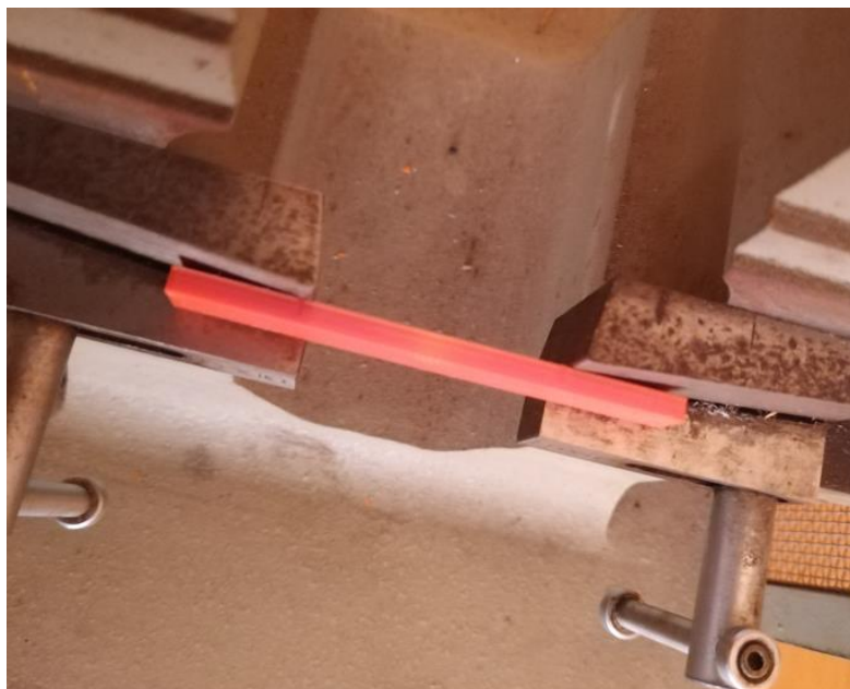
Рисунок 17. – Положение образца при последующим ударе плашмя
