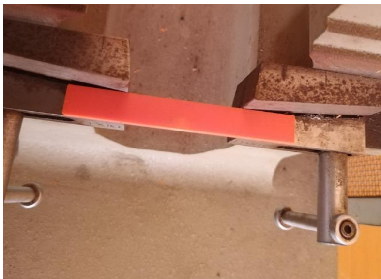
Рисунок 16. – Положение образца при последующим ударе в ребро
