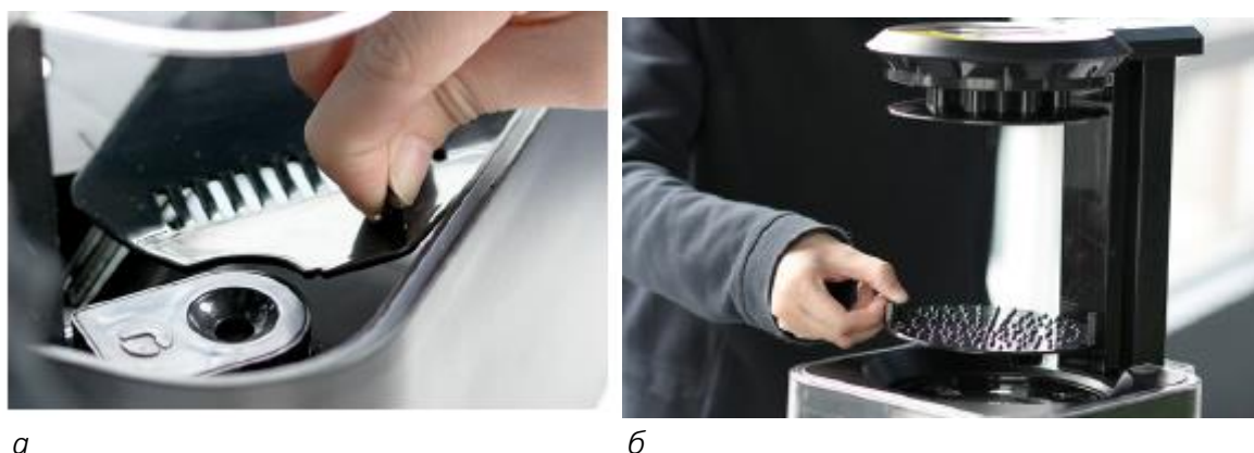
Рисунок 6. – Установка крышки (а) и платформы (б) внутри устройства
