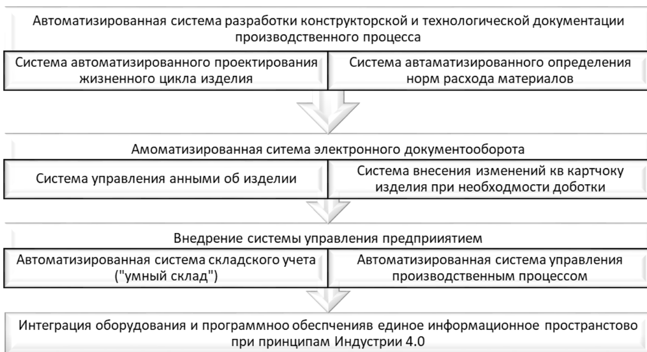
Рисунок 1. – Этапы цифровой трансформации инновационного промышленного производства в рамках реализации концепции «Индустрия 4.0»
