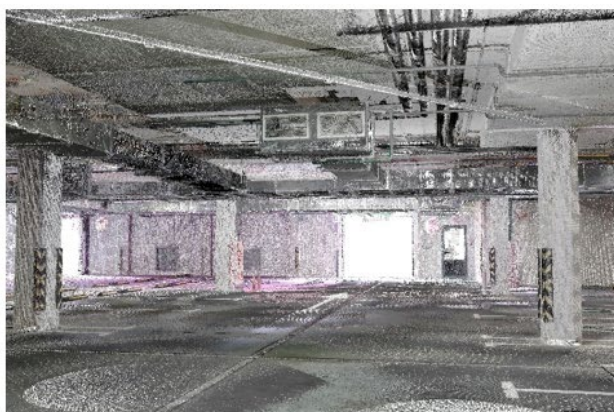
Рисунок 5. – Общий вид облака точек и цифровой модели объекта с использованием BIM-технологии
