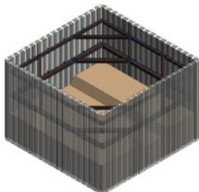
Цифровая модель ограждающих конструкций котлована
