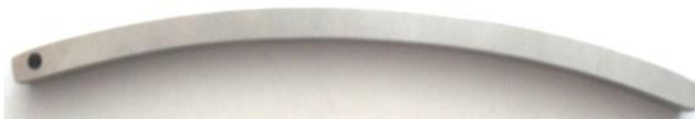
Рис. 4. Образец для испытаний на коррозионную стойкость (натуральная величина)
