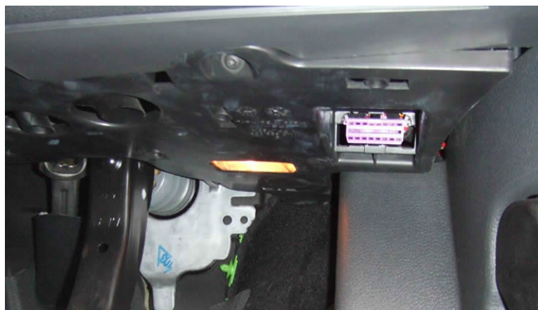
Рисунок 3 — Расположение порта компьютерной самодиагностики в автомобиле
