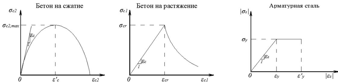
Рис. 2. Диаграммы деформирования материалов, используемые в расчетах по «МТСП»
