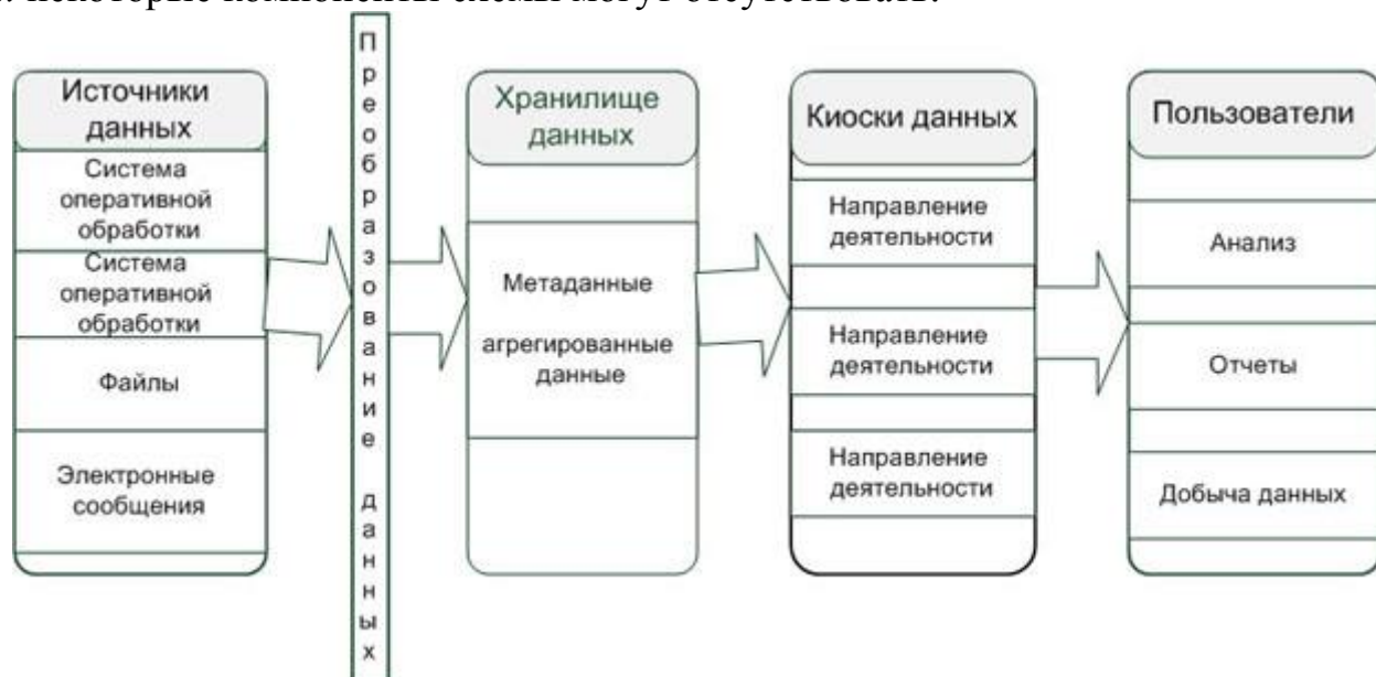
Рисунок - Типовая обобщенная концептуальная схема для архитектуры ХД
