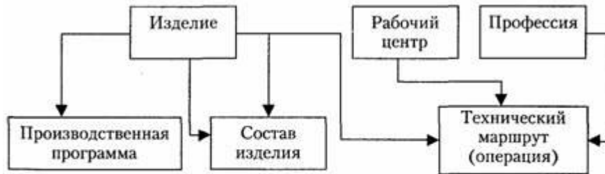
Рис. 4.3. Типовая структура информационной базы, поддерживаемая продуктами класса CRP
