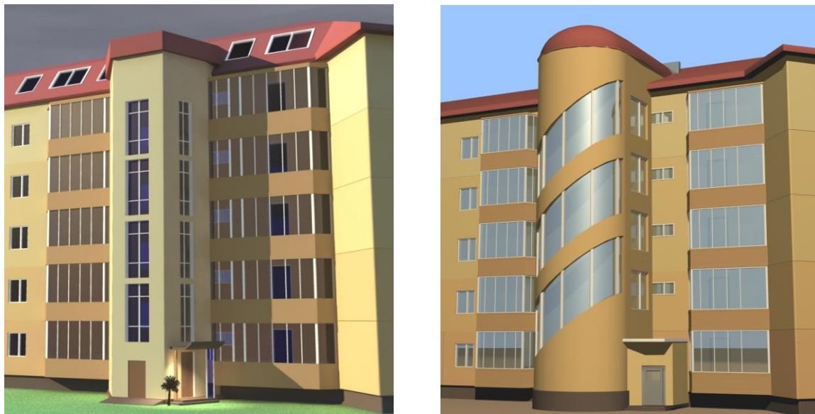
Рис. 3. Фасад с лифтовой пристройкой в форме пятигранной призмы и цилиндрической части
