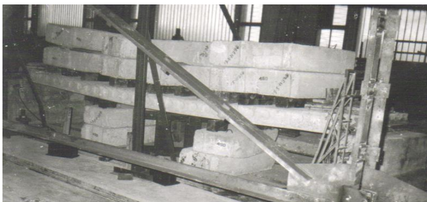
Рис. 4. Загружение опытных образцов равномерно распределенной нагрузкой
