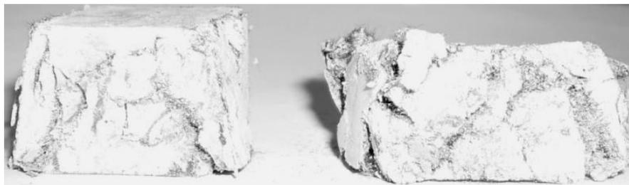
Рис. 2. Характер разрушения цементного камня с фиброй
