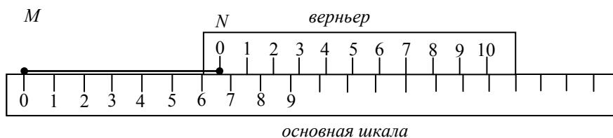
Рис. 1.22. Принцип измерения по верньеру
