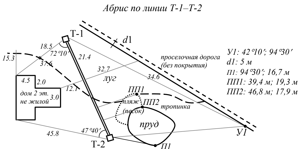
Рис. 6.7. Пример абриса по линии теодолитной съемки
