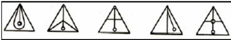
Рис. 2.3. Древнейшие геометрические горизонтирующие устройства
