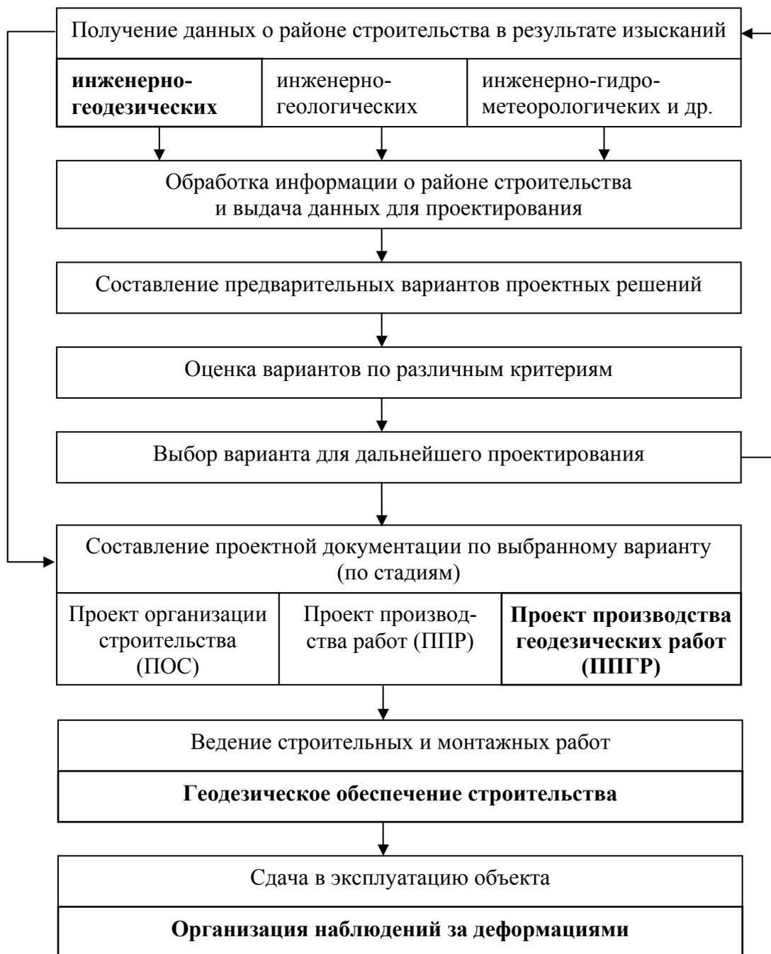
Рис. 1. Основные этапы строительства и его геодезического обеспечения
