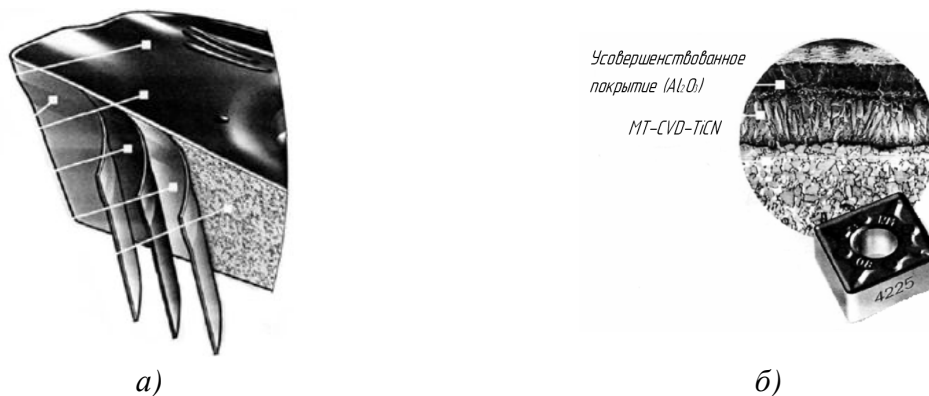
Рис. 5.8. Внешний вид многослойного покрытия MT-CVD TiCN в сочетании со слоем Al 2 O 3 (а) и его структура (б)
