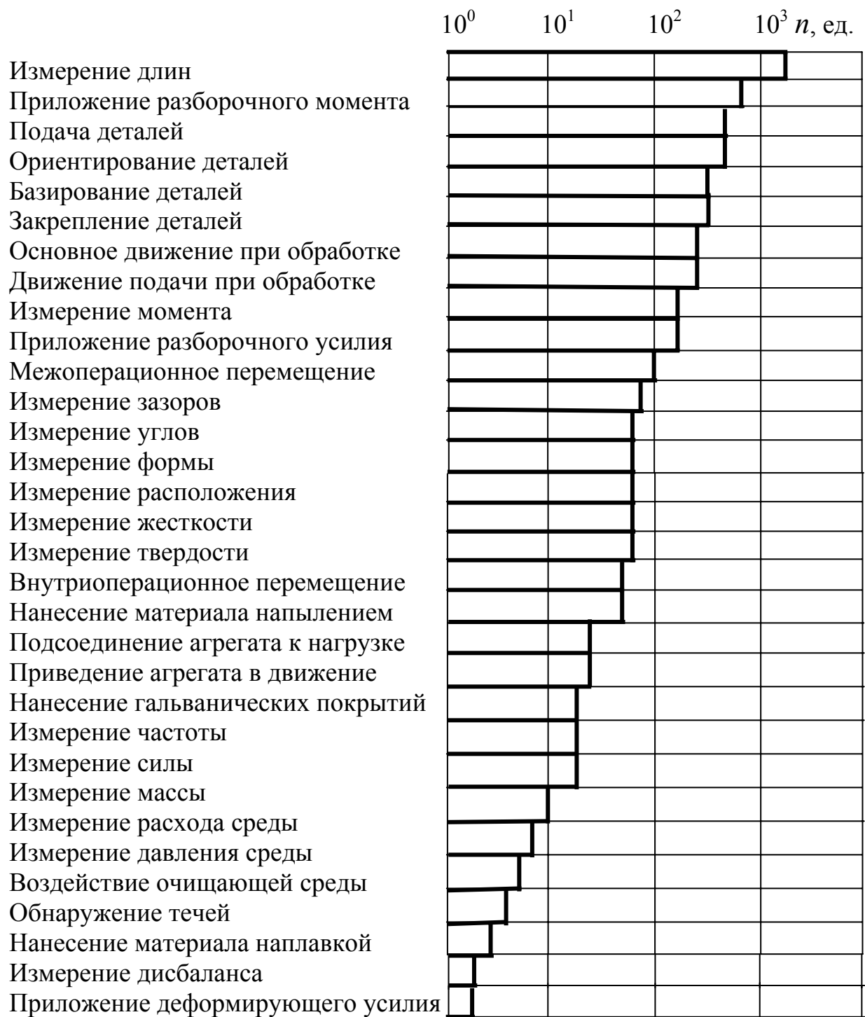
Рис. 1.5. Количество n технологических переходов, приходящихся на ремонт одного двигателя внутреннего сгорания
