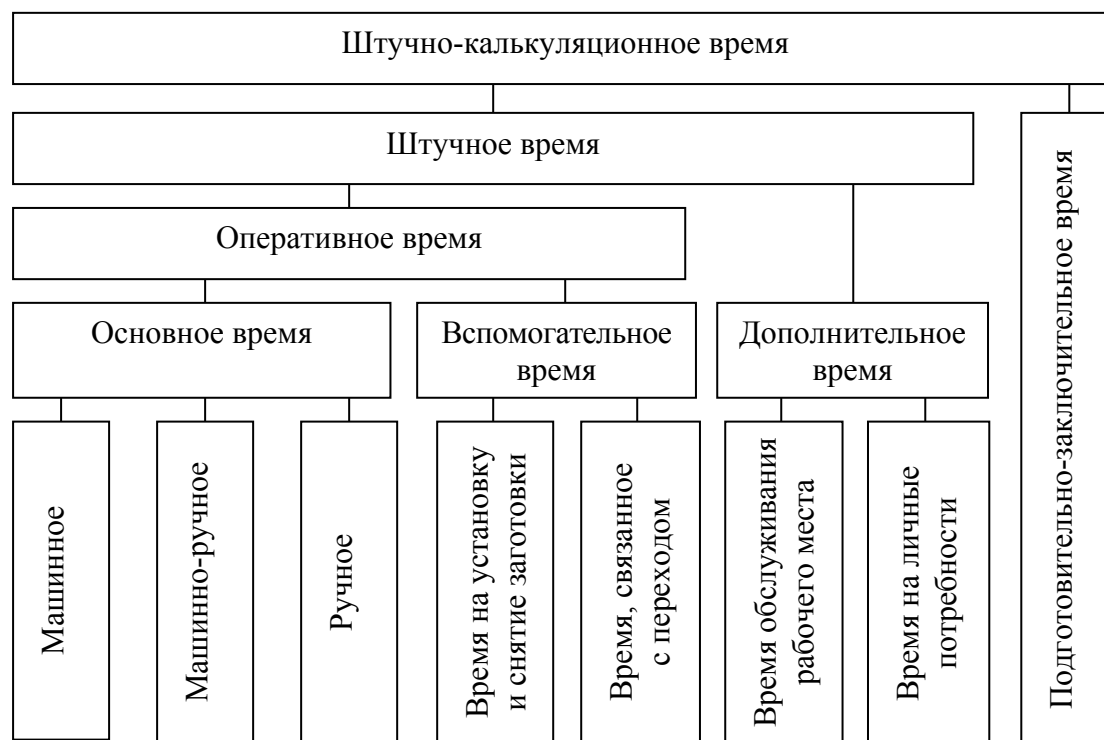
Рис. 6.1. Структура штучно-калькуляционного времени
