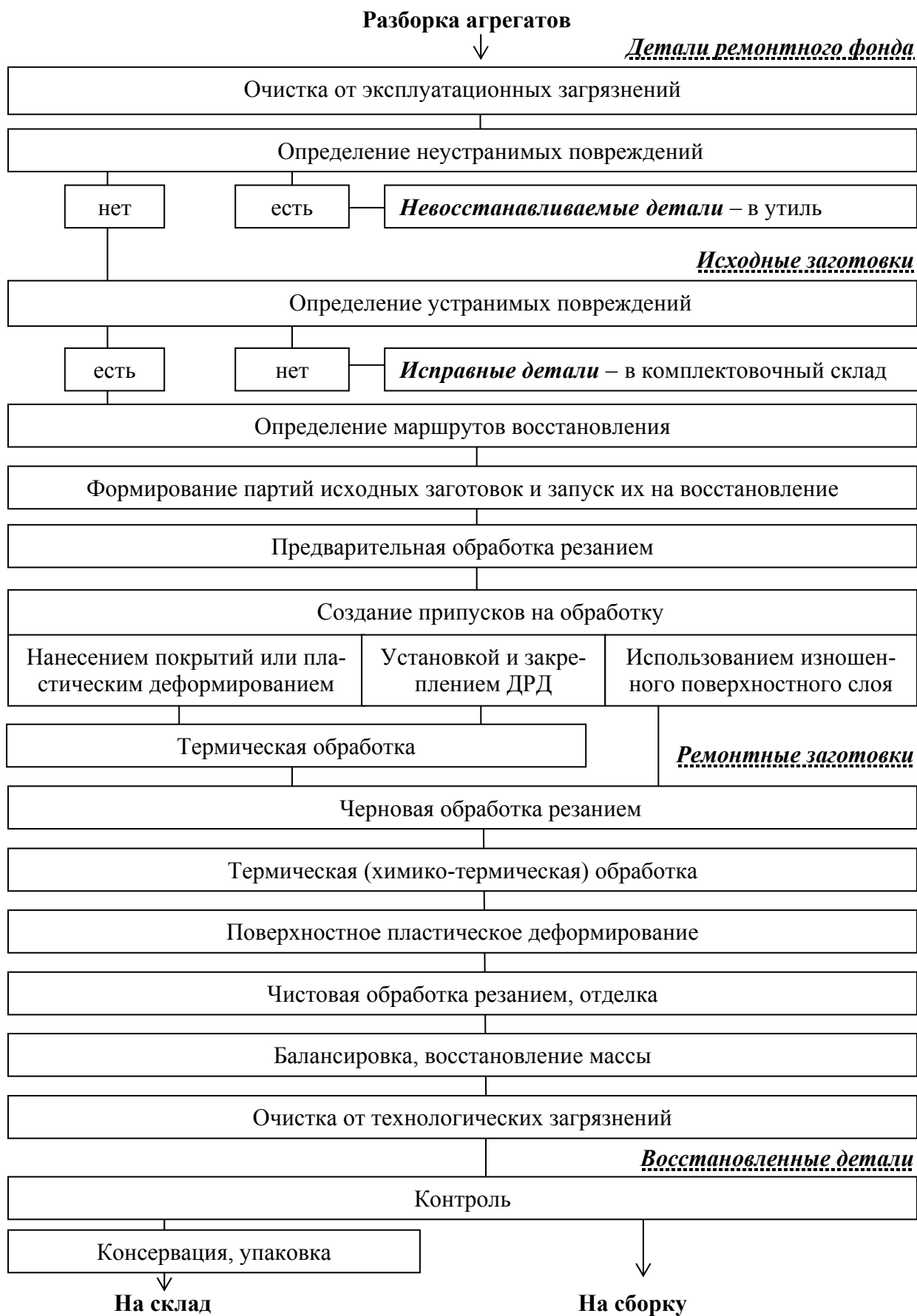
Рис. 3.1. Схема технологического процесса восстановления деталей
