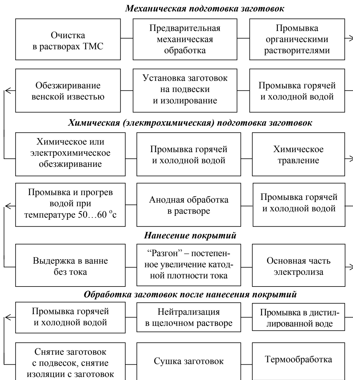
Рис. 3.36. Схема технологического процесса нанесения электрохимических покрытий
