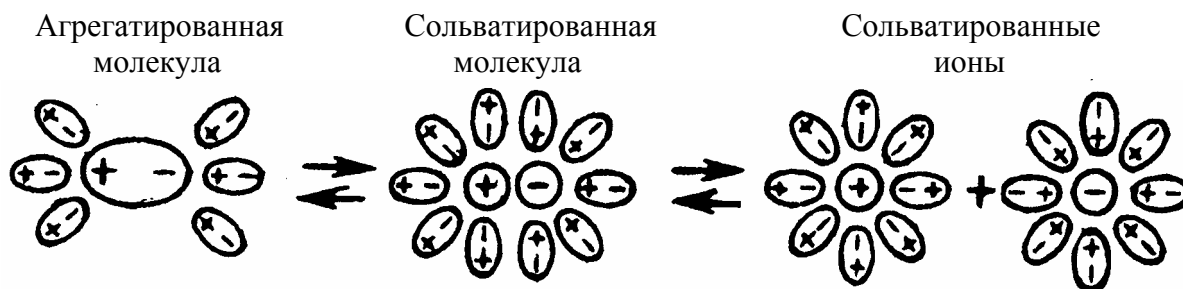
Рис. 3.35. Схема образования сольватированных ионов из молекулы в результате электролитической диссоциации
