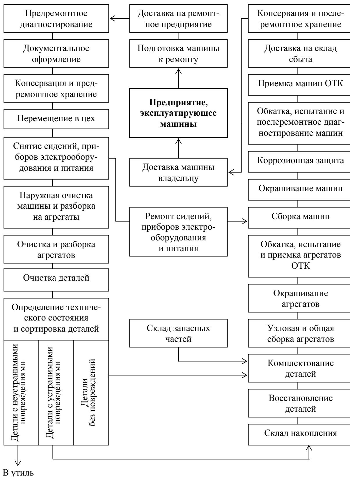
Рис. 1.3. Схема производственного процесса ремонта машин
