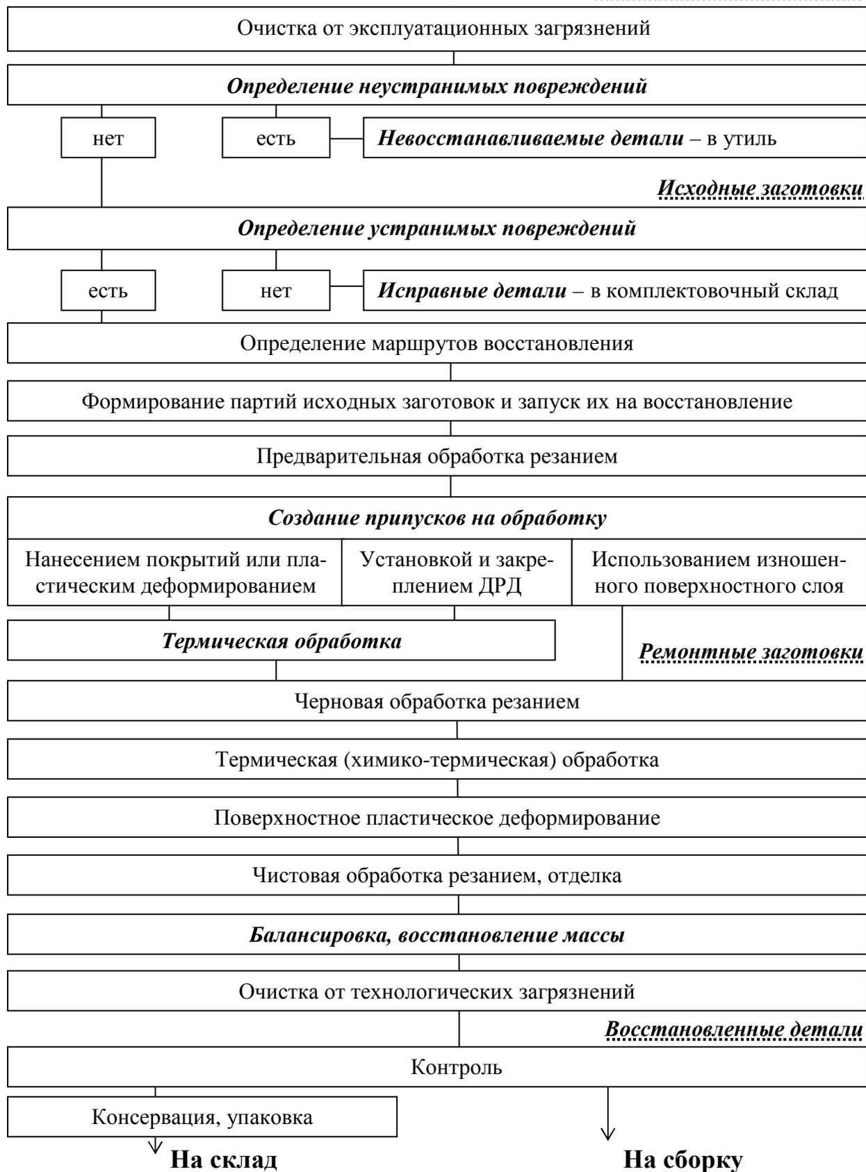
Рис. 2.3. Схема технологического процесса восстановления деталей
