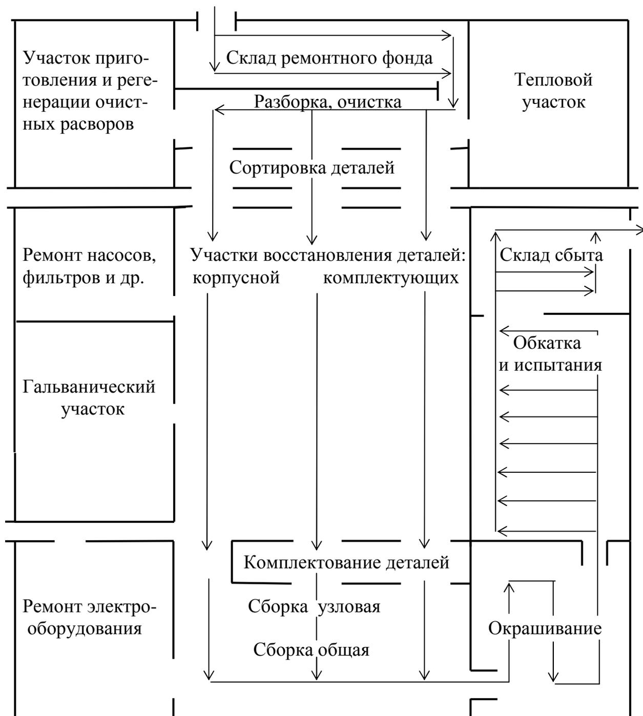
Рис. 1.10. Схема расположения производственных участков в производственном корпусе агрегатно-ремонтного завода
