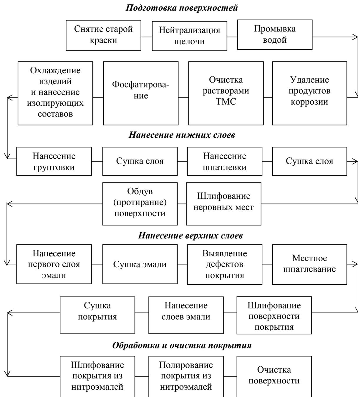
Рис. 2.11. Схема технологического процесса окрашивания машин
