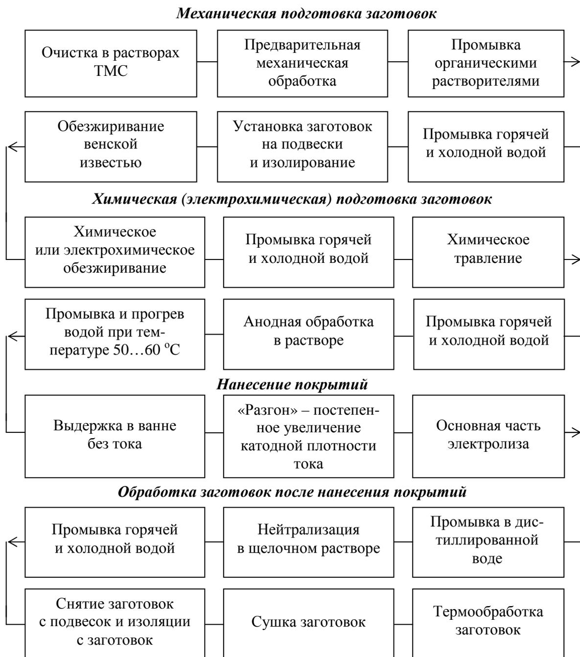
Рис. 2.5. Схема технологического процесса нанесения электрохимических покрытий
