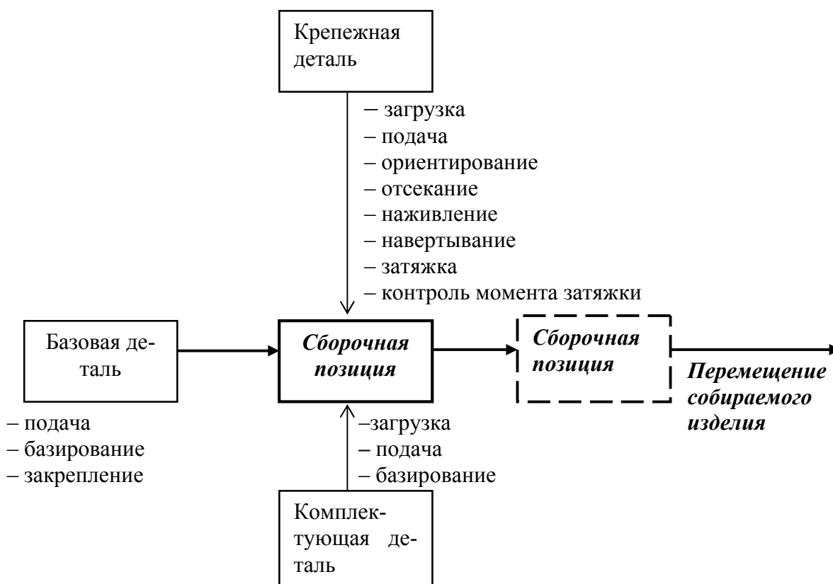
Рис. 4.8. Схема сборочной операции
