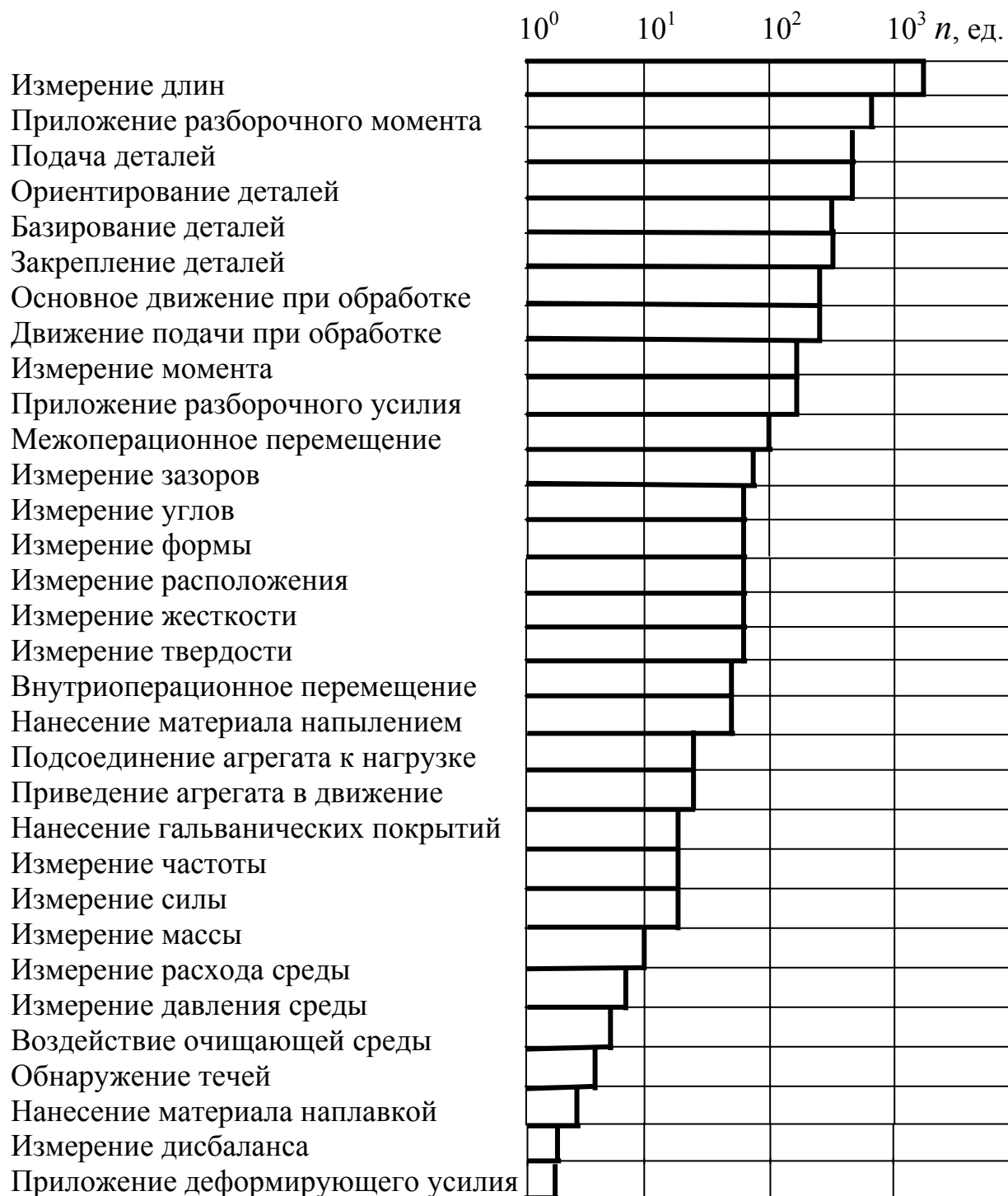
Рис. 1.1. Количество n технологических переходов, приходящихся на ремонт одного двигателя внутреннего сгорания
