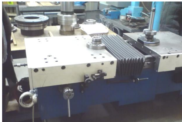
Рис. 5. Прибор для двухпрофильного контроля ВЗ-581
