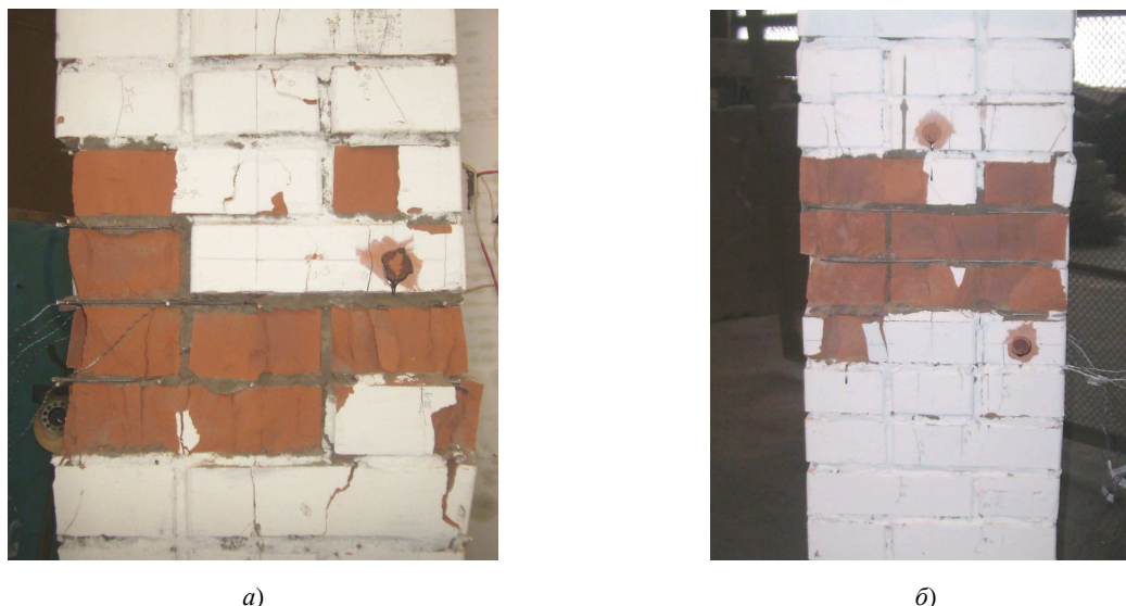
Рис. 3. Характер разрушения образцов, армированных сетками: а – тип сетки А; б – тип сетки Б
