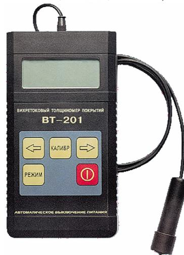
Рис. 2.4.-2. Толщиномер ВТ-201
