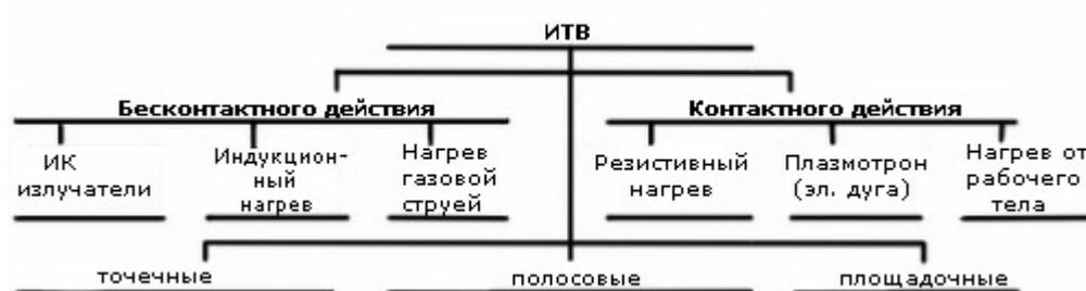
Рис. 2.10.2.-1. Классификация источников теплового возбуждения
