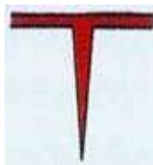
Рис. 2.5.-2. Нанесение пенетранта на поверхность дефекта
