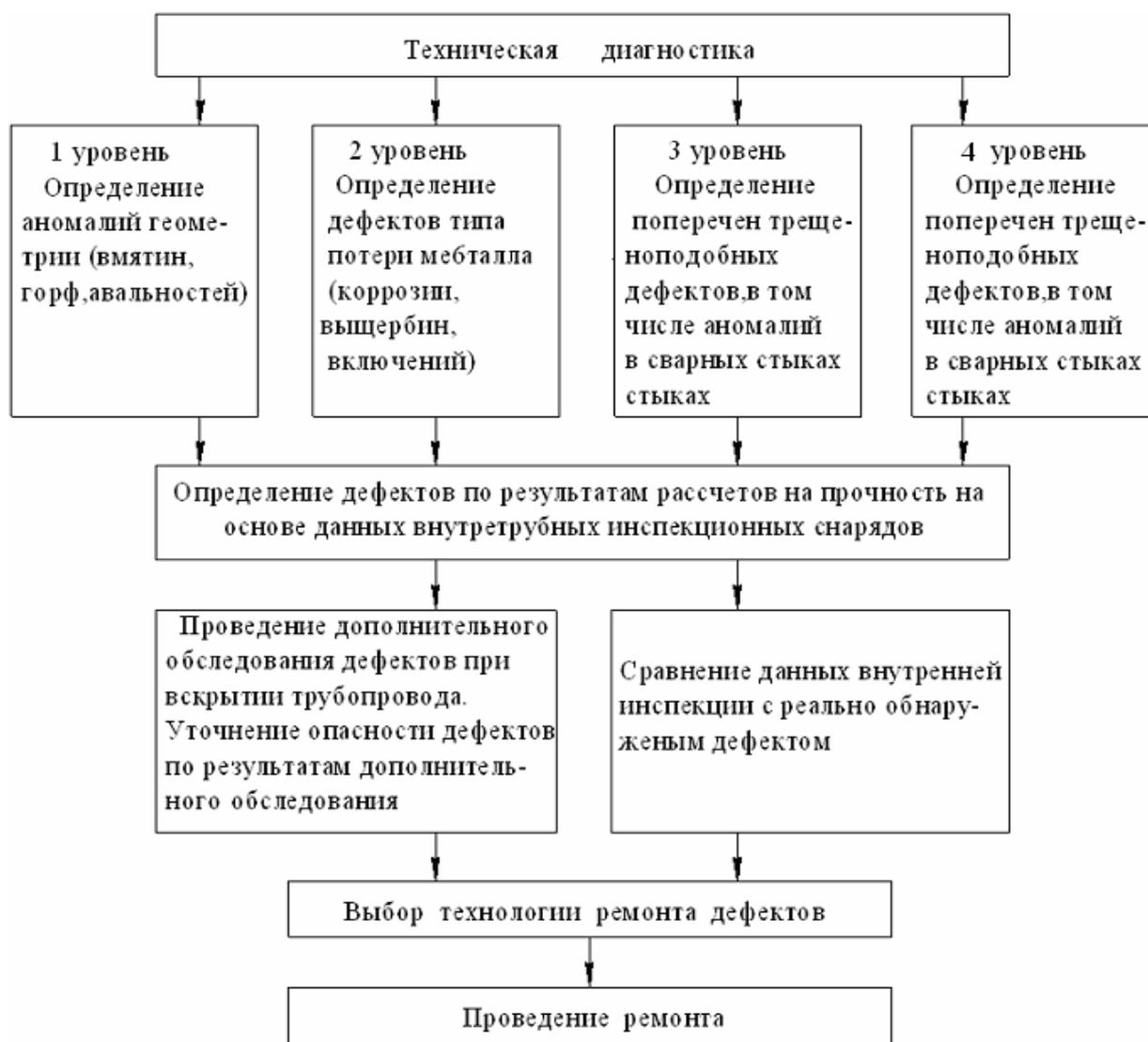
Рис 2.13.2.-1. Схема комплексного 4-уровневого диагностического контроля магистральных трубопроводов
