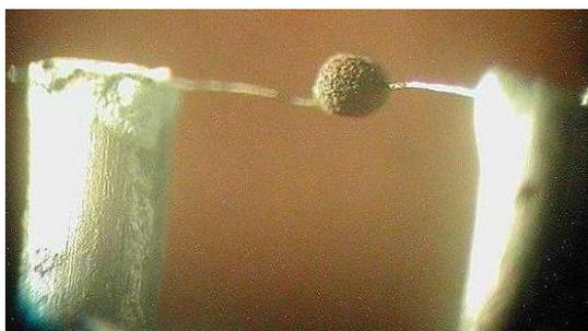
Рис. 1. Внешний вид термокаталитического сенсора, разваренного в корпус
