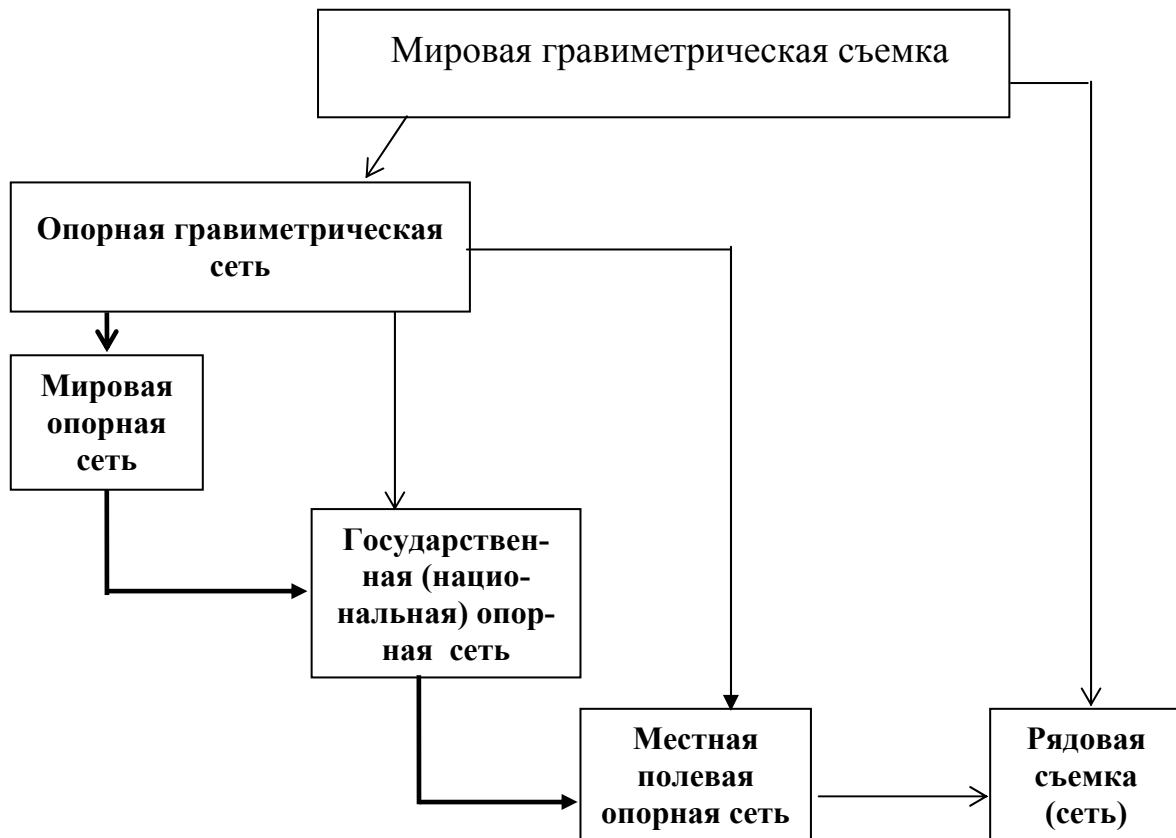
Рис. 26. Схема организации мировой гравиметрической съемки по принципу от общего к частному
