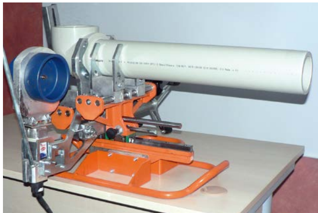
готовое сварное соединение после охлаждения
