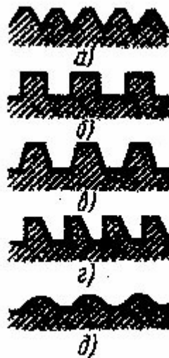
Рис. 100. Профили резьб: а — треугольная, б — прямоугольная, в — трапе- цендальная, г — упорная, д — круглая
