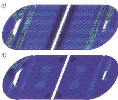
Рис. 6. Распределение изгибающих моментов вдоль оси X (а) и оси Y (б) в плите основания ледового поля конькобежного стадиона
