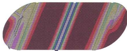
Рис. 3. Вертикальное давление в подошве плиты основания ледового поля конькобежного стадиона
