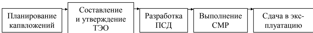
Рис. 1. Инвестиционный цикл строительства
