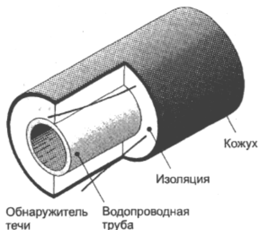
Рис. 33. Схема элемента предварительно изолированного тепловпровода
