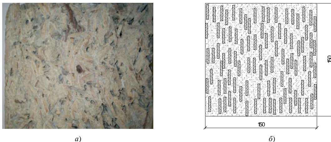
Рис. 3. Композит с наполнителем в виде однонаправленных волокон а – фотоснимок; б – модель
