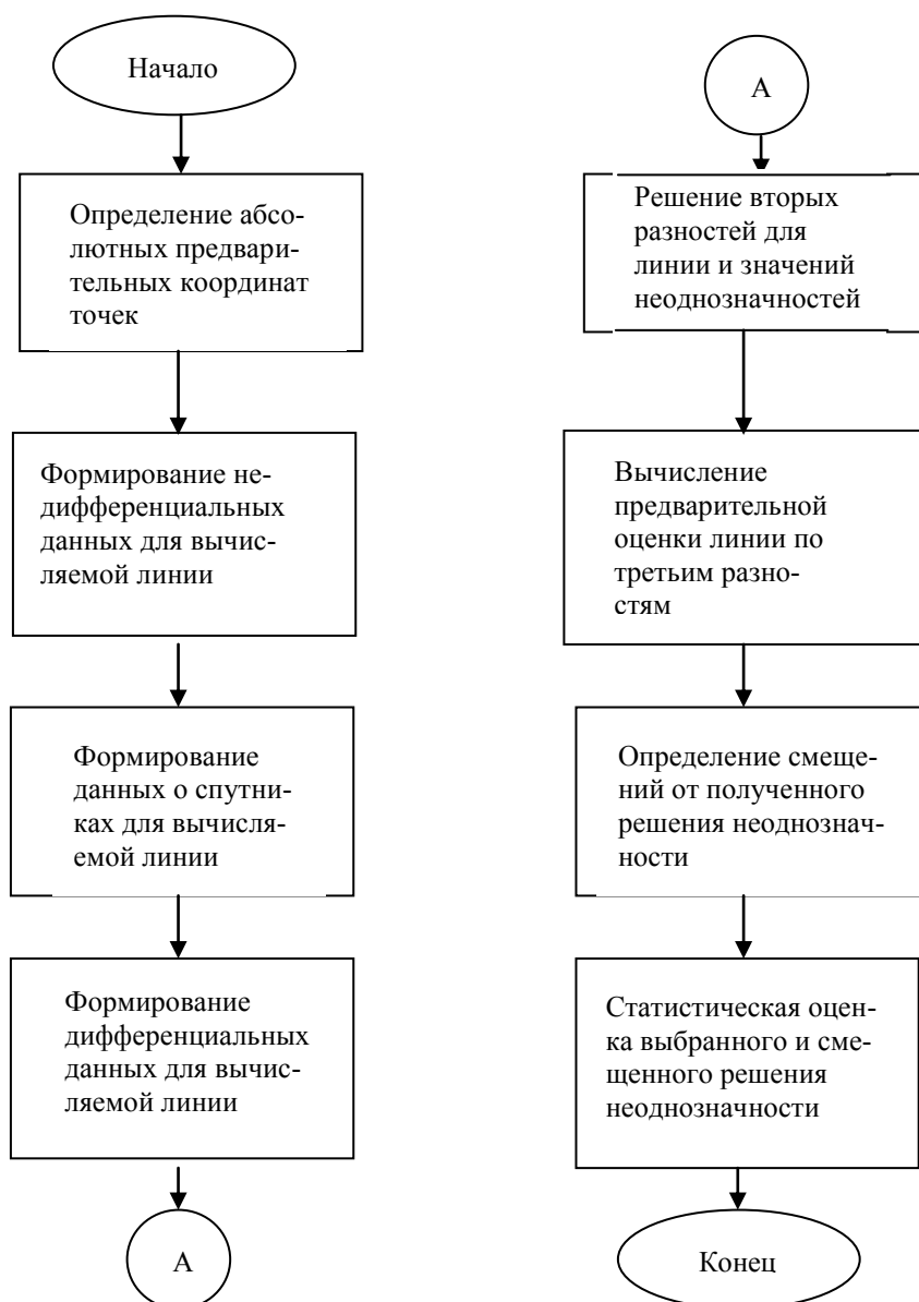
Рис. 9. Общий алгоритм вычисления отдельной линии
