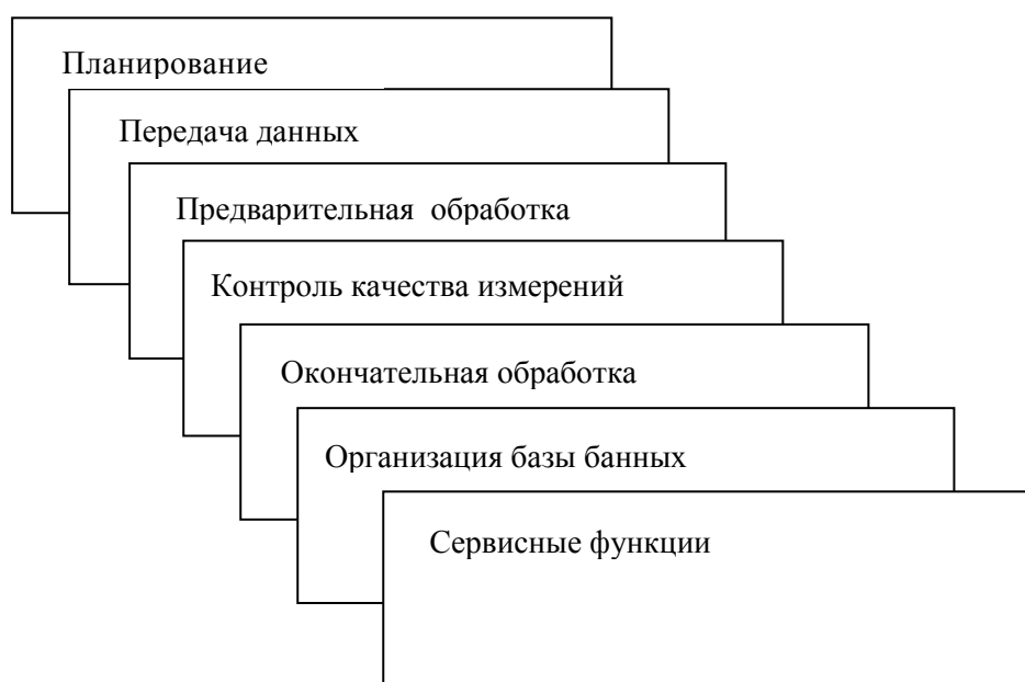
Рис. 12. Общая структура программы обработки фирмы-изготовителя спутниковых приемников
