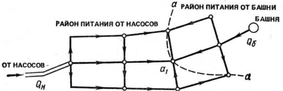
Рис. 2.4. Система водоснабжения с контррезервуаром
