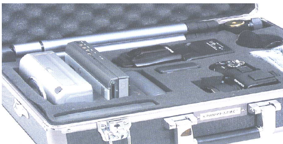
Рис. 3. Перспективная версия мобильного комплекса технических средств ТКО цифровой фиксации и обработки криминалистических данных (МК ЦФОКД).
