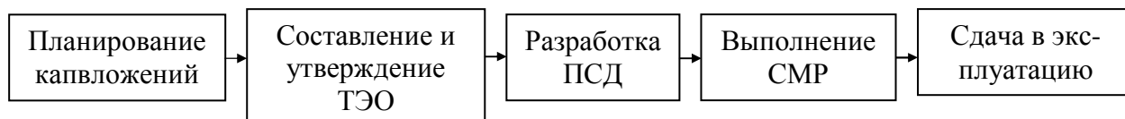
Рис. 1.1. Инвестиционный цикл строительства
